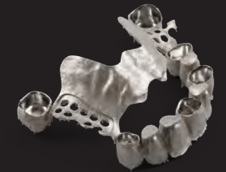
Fräsergebnisse mit hoher Oberflächengüte
